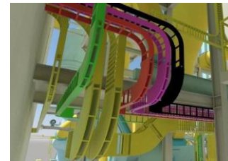
Fábrica de Cementos Molins. Río Claro (Colombia). Elebobisa + OHL Industrial. Instalaciones eléctromecánicas área de piroproceso y alumbrado. Modelado BIM con Revit.
